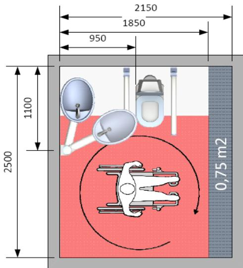
Radio de giro 1850x1850 mm para sillas de ruedas manuales o eléctricas.
