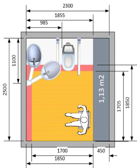
Radio de giro 1850x1850 mm para sillas de ruedas manuales o eléctricas.
